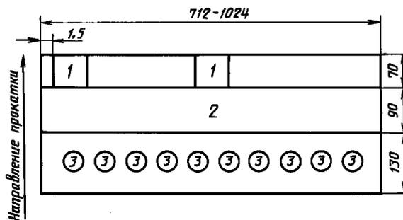
1 — образцы для измерения твердости (70×70 мм); 2 — полоса шириной 90 мм для испытания на выдавливание лунки по Эриксену; 3 — образцы для определения массы оловянного покрытия (Ø 20 мм)
