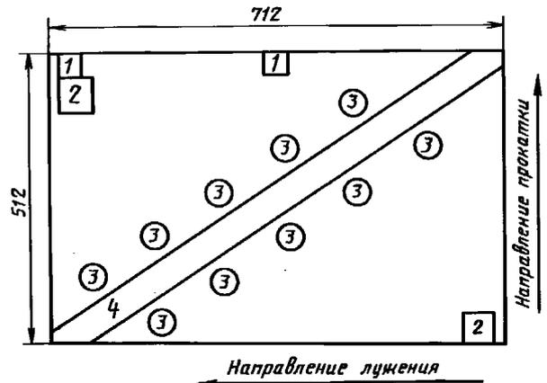
1 — образцы для измерения твердости (70×70 мм); 2 — образцы для измерения оловянного покрытия (100×100 мм); 3 — образцы для определения массы оловянного покрытия (Ø 20 мм); 4 — полоса шириной 90 мм по диагонали листа для испытания на выдавливание лунки по Эриксену
