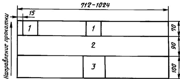
1 — образцы для измерения твердости (70×70 мм); 2 — полоса шириной 90 мм для испытания на выдавливание лунки по Эриксену; 3 — образец для определения параметра шероховатости (100×100 мм)
